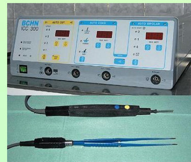
Nahore elektrokoagulační přístroj, dole elektrokauter a bipolární pinceta
